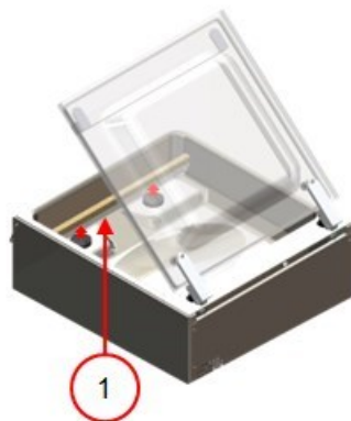
Schéma 13: Retrait de la barre de soudure
