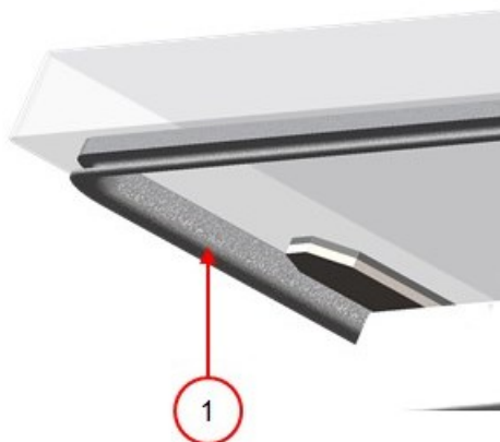
Schéma 16: Remplacement du joint du couvercle
