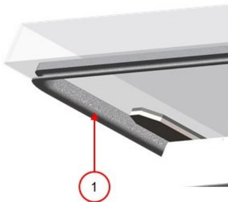
Schéma 22: Remplacement du joint du couvercle
